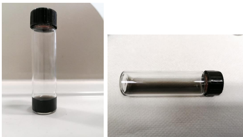
Slika 23. Kompozit kitozan–CNT i inzulin s reguliranim pH.
