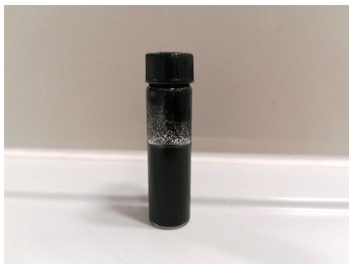
Slika 18. Nanovo pripravljena suspenzija CNT-COOH u kitozanskom gelu u masenom omjeru 1:1.
