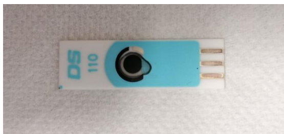
Slika 21. Screen printed carbon elektroda modificirana kompozitnim filmom kitozan–CNT s inzulinom.
