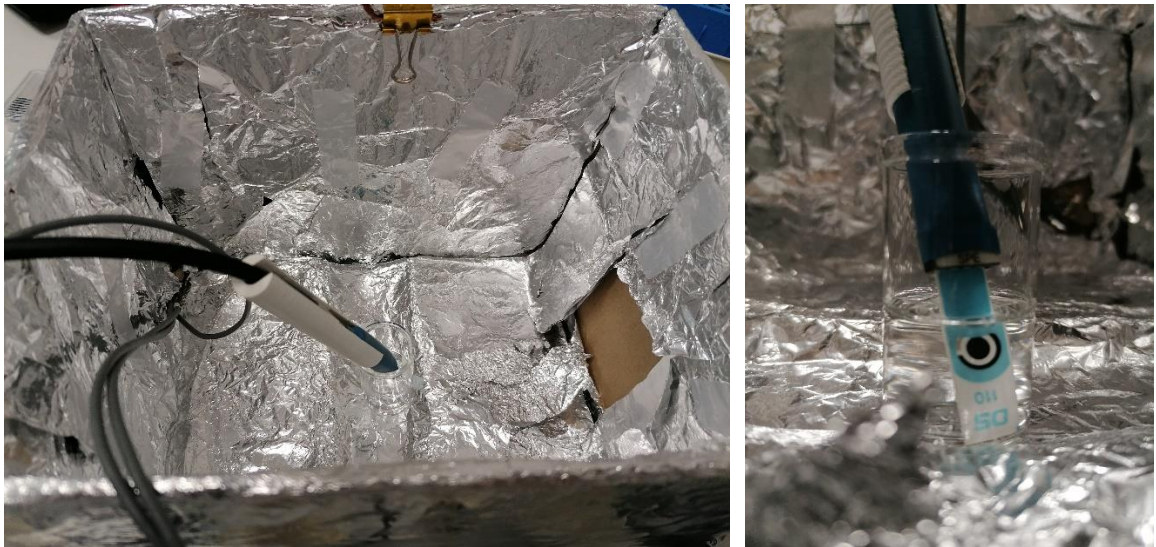
Slika 19. Sustav za amperometrijsko određivanje kalibracijske linije inzulina.
