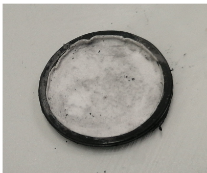
Slika 48. Gornji dio Litjevog akumulatora
