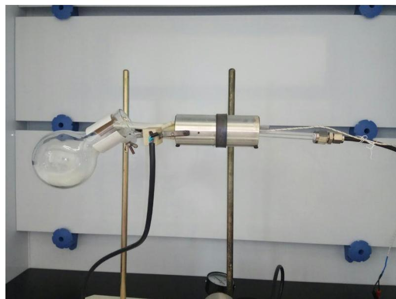
Slika 45. Zračni kondenzator
