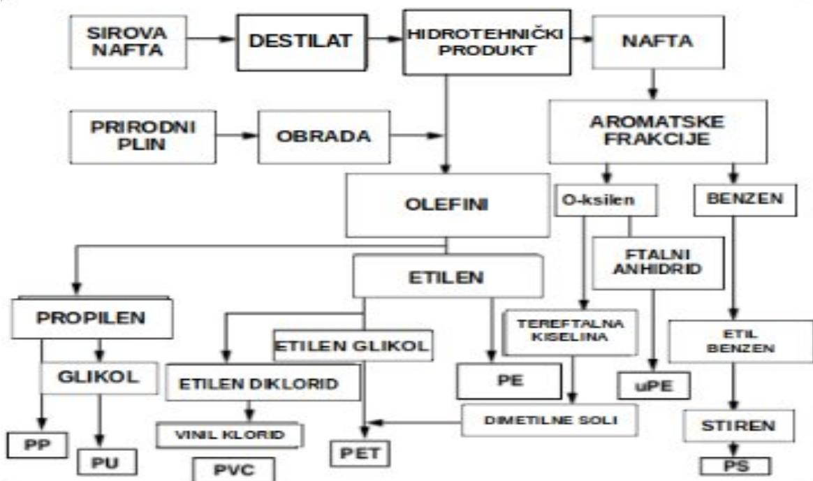
Slika 23. Shematski prikaz reakcijskog puta od fosilnih sirovina prema plastičnim polimerima [29]
