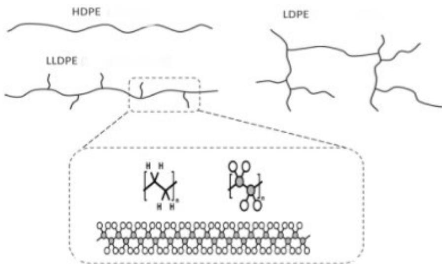
Slika 18. Strukturalna okosnica PE; schematski prikaz struktura HDPE, LDPE I LLDPE [22] [1]
