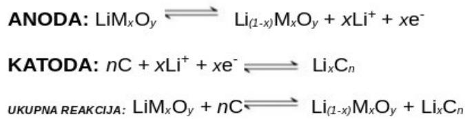
Slika 43. Osnovna elektrokemijska reakcija litijskog akumulatora; jednaždžbe polureakcija koje se odvijaju na katodi i anodi
