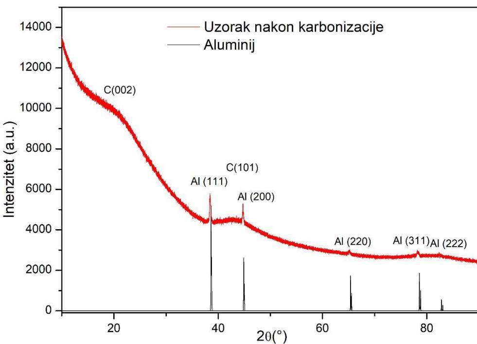
Graf 2. Difraktogram uzorka PET-a nakon provedene karbonizacije
