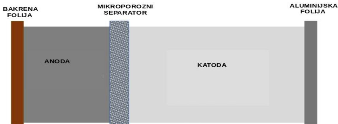
Slika 41. Generalni prikaz konstrukcije elektrokemijske ćelije litijskog akumulatora
