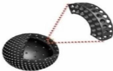
Slika 34. Schematski prikaz strukture ugljikovih šupljih sfera [50]
