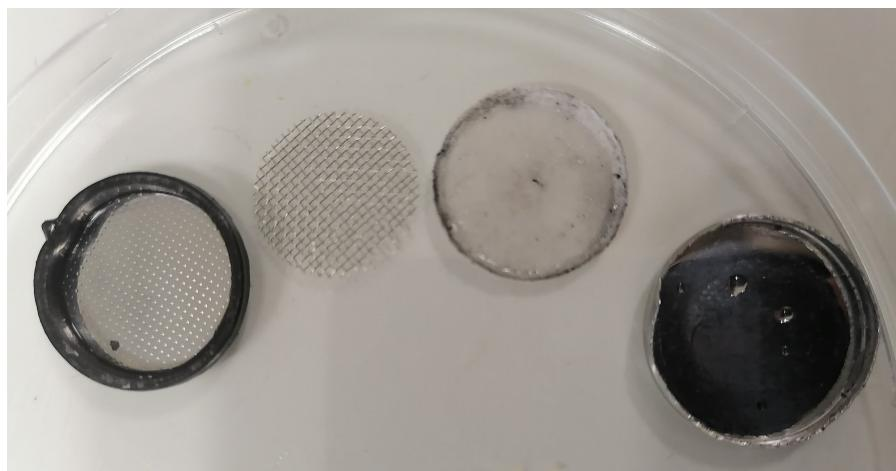
Slika 47. Očišćene konstrukcijske komponente litijeve baterija tipa CR2032
