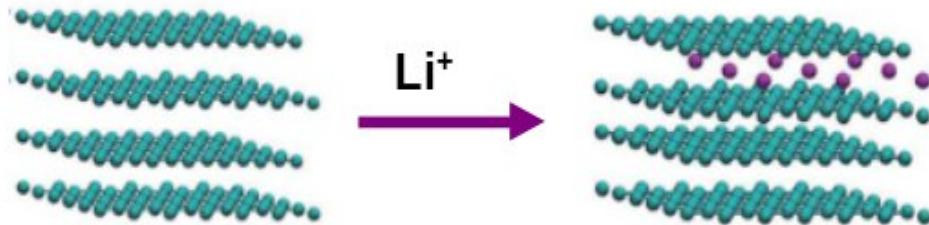
Slika 37. Intercaliranje grafitne elektrode [60]
