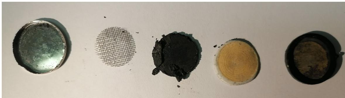
Slika 46. Konstrukcijske komponente litijeve baterija tipa CR2032
