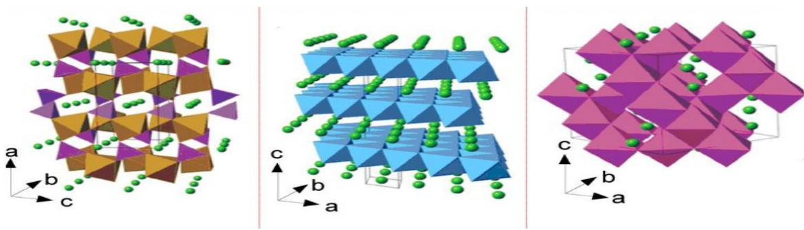
Slika 35. Shematski prikazi olivinske, slojevite i spinelne (redom s lijeva na desno) morfologije katodnih materijala [59]
