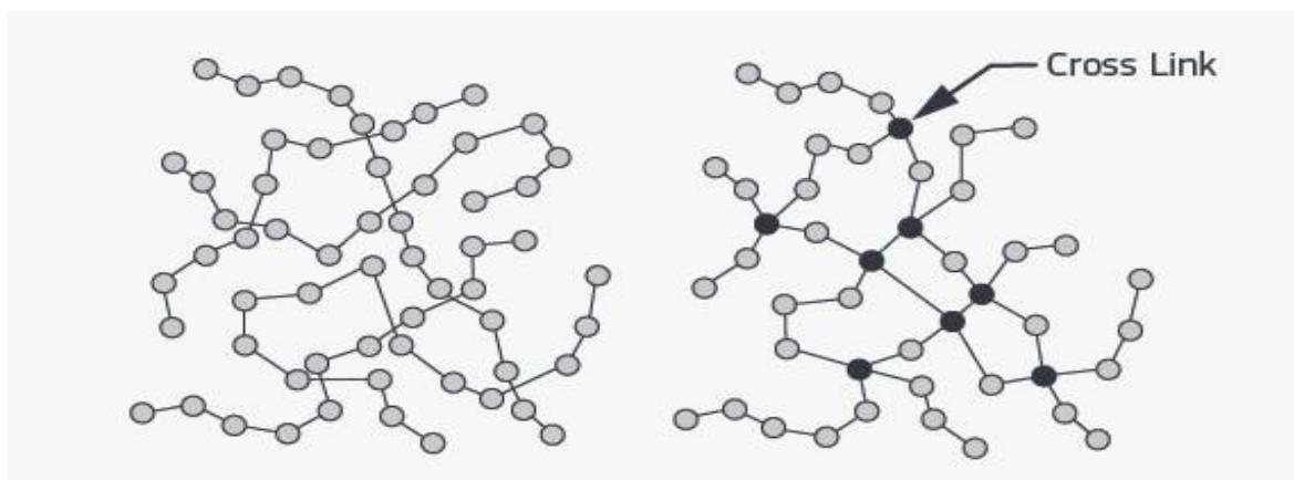
Slika 6. prikaz strukture termoplastičnih (lijevo) i termoreaktivnih materijala [16]
