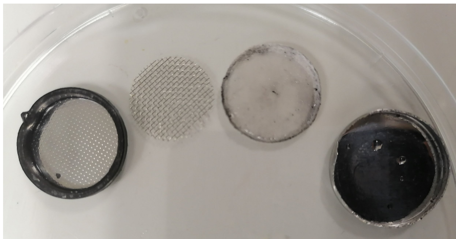
Slika 47. Očišćene konstrukcijske komponente litijeve baterije tipa CR2032
