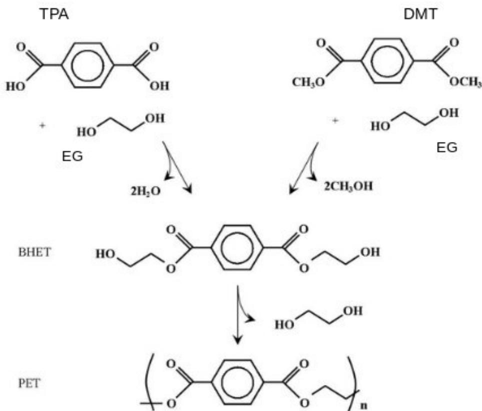
Slika 21. Shematski prikaz reakcijskih puteva sinteze PET-a [27]
