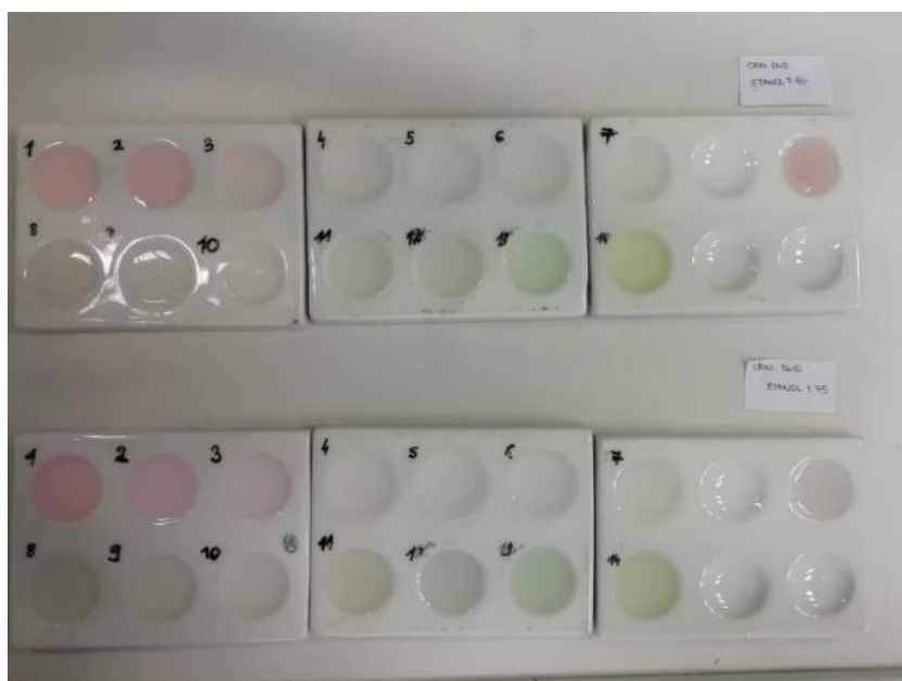
Slika 39. Rezultati primjene indikatora od svježeg crnog duda i 50 % etanola (gore) i 75 % etanola (dolje).
