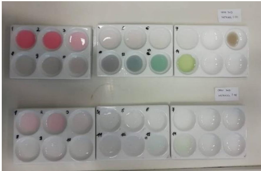
Slika 41. Rezultati primjene indikatora od svježeg crnog duda i 50 % metanola (gore) i 75 % metanola (dolje).
