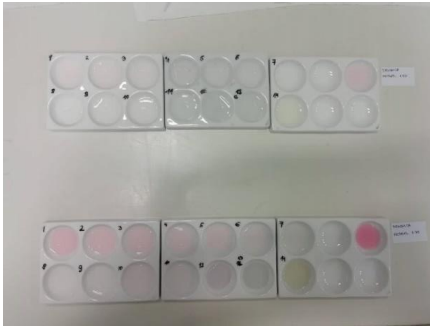
Slika 49. Rezultati primjene indikatora od svježe brusnice i 50 % metanola (gore) i 75 % metanola (dolje).
