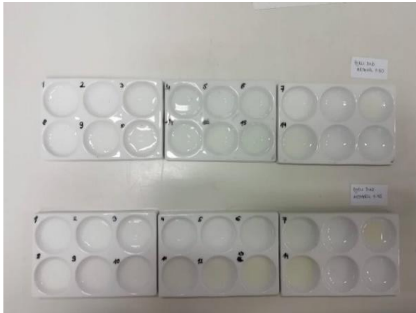
Slika 37. Rezultati primjene indikatora od svježeg bijelog duda i 50 % metanola (gore) i 75 % metanola (dolje).
