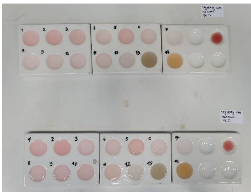
Slika 82. Rezultati primjene indikatora od suhih tayberry bobica i 50 % metanola (gore) i 75 % metanola (dolje).
