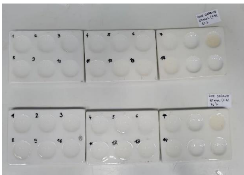
Slika 68. Rezultati primjene indikatora od grožđica i 50 % etanola (gore) i 75 % etanola (dolje).
