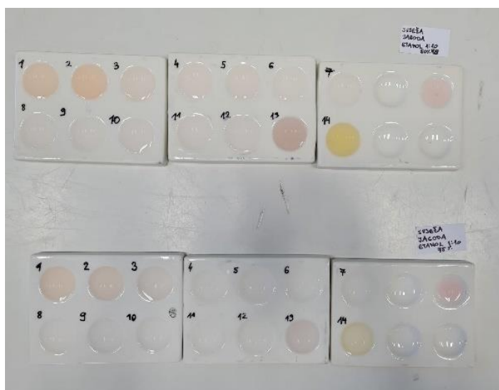
Slika 19. Rezultati primjene indikatora od svježe jagode i 50 % etanola (gore) i 75 % etanola (dolje).
