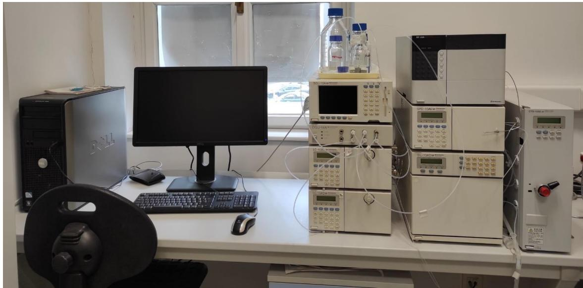
**Slika 13.** Uredaj za kromatografiju visoke djelotvornosti (Shimadzu).
