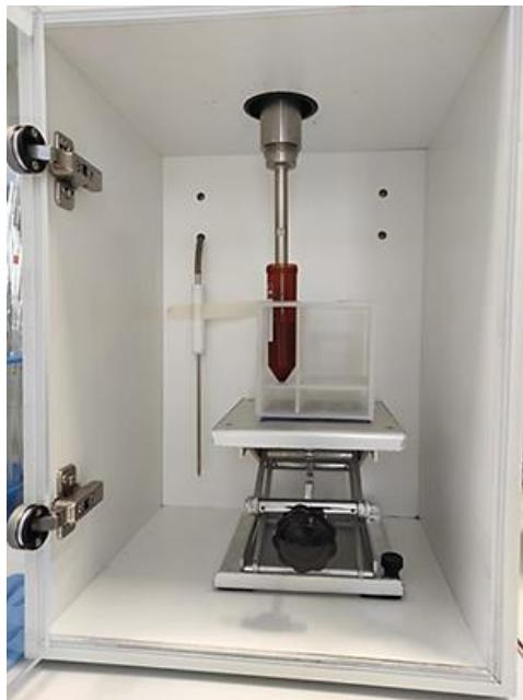
**Slika 16.** Direktna ekstrakcija potpomognuta ultrazvukom (UZVS).
