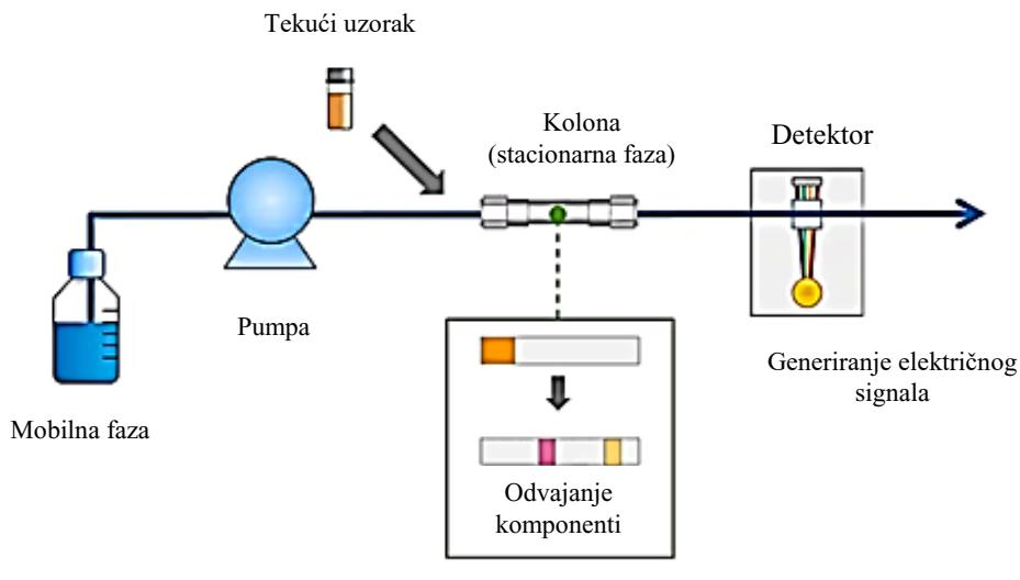
**Slika 7.** Dijelovi HPLC-a. [33]
