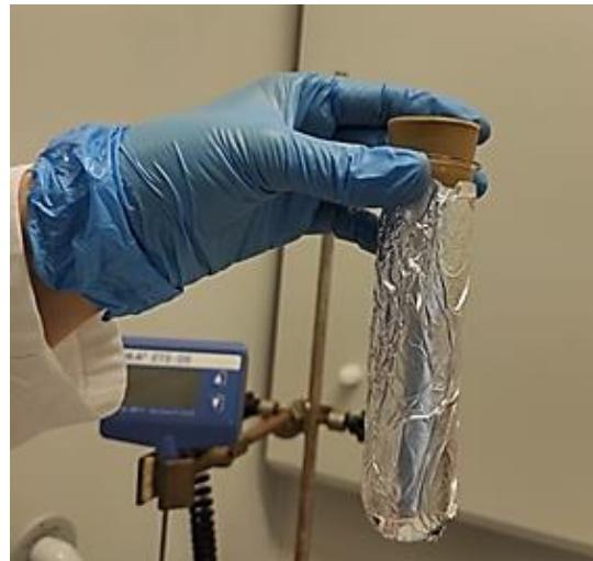
**Slika 14.** Epruveta obložena aluminijskom folijom prije zagrijavanja.
