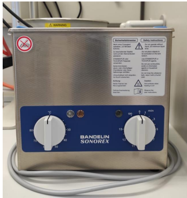
Slika 11. Ultrazvučna kupelj s regulatorom temperature (Bandelin, Berlin, Njemačka).
