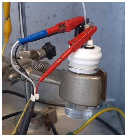
Slika 9. Troelektrodna voltametrijska ćelija.
