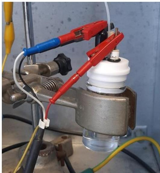
Slika 9. Troelektrodna voltametrijska čelija.
