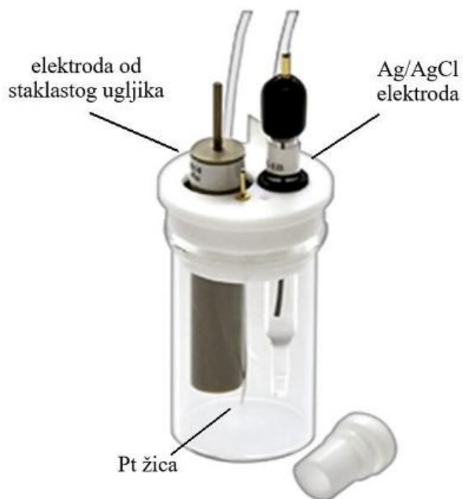
Slika 15. Prikaz elektroda u troelektrodnoj voltametrijskoj ćeliji. Radna elektroda – GC elektroda, referentna elektroda – Ag/AgCl, protuelektroda – platinska žica.
