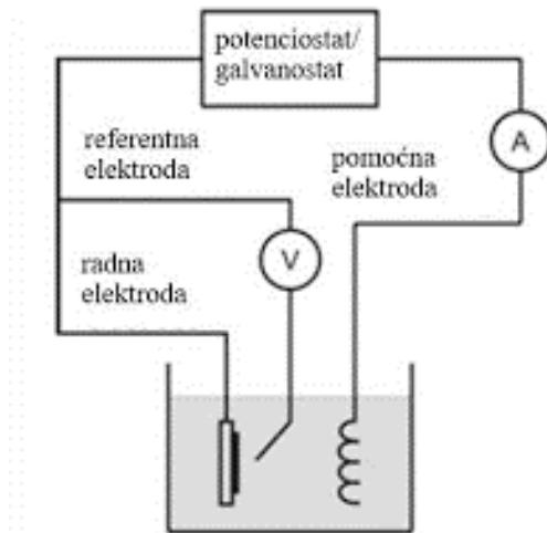
**Slika 8.** Troelektrodni voltametrijski sustav [24].
