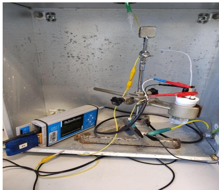
**Slika 13.** PalmSens potenciostat/galvanostat.
