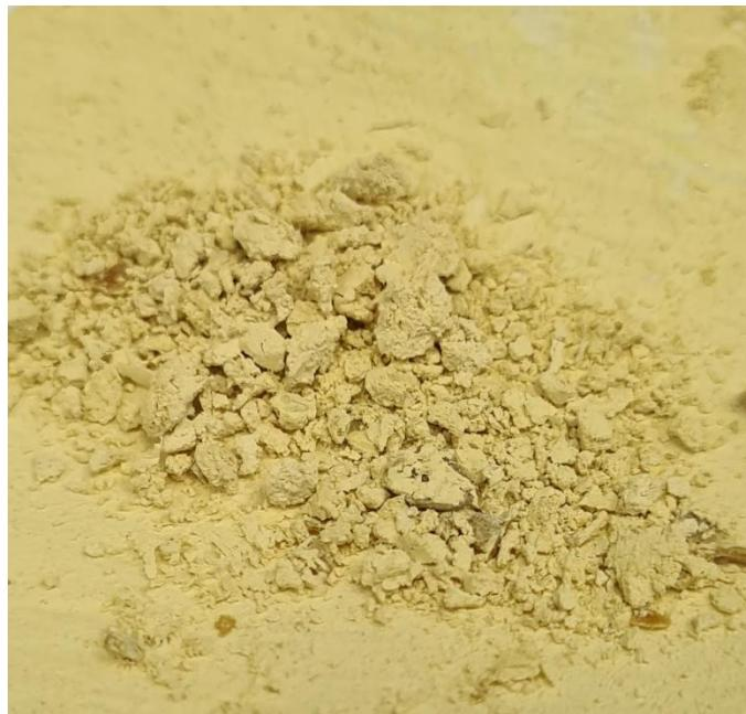
**Slika 14.** Kristali sintetizirane Schiffove baze pDo5.
