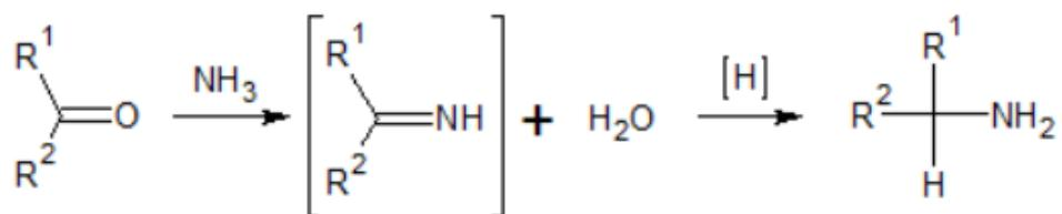
*Slika 5. Reakcija nastajanja amina iz aldehida [11].*
