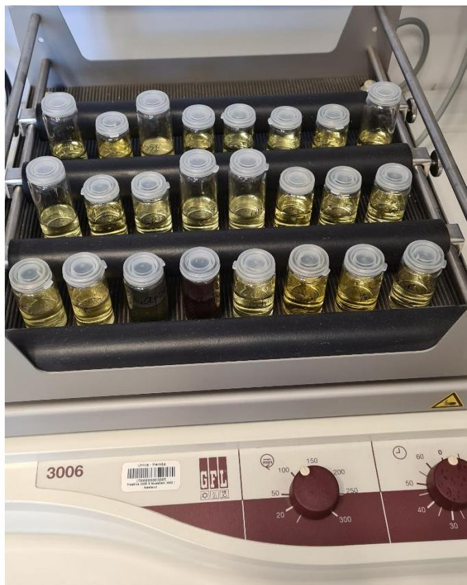
**Slika 16.** Pripremljeni uzorci na mehaničkoj tresilici.
