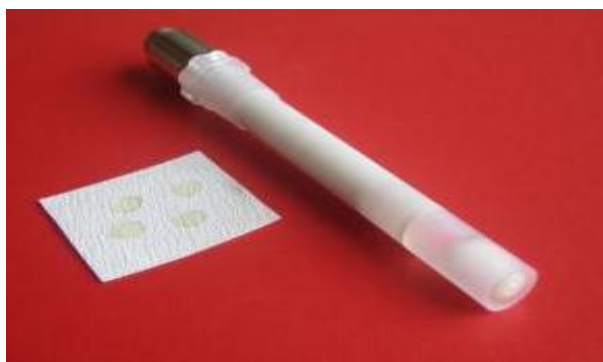
Slika 15. Tenzidno-osjetljiva elektroda sa PVC membranom.
