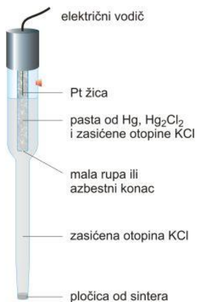
Slika 5. Kalomel elektroda.
