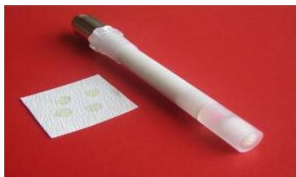
Slika 15. Tenzidno-osjetljiva elektroda sa PVC membranom.
