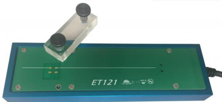
**Slika 10.** ET121 mikročip platforma za C<sup>4</sup>D detektor [46].
