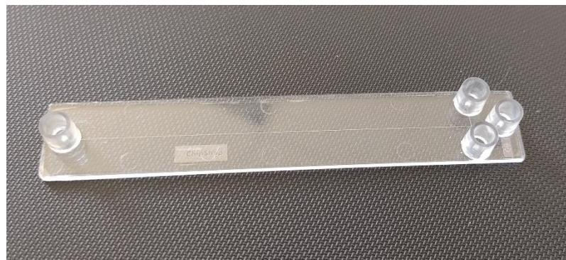
**Slika 12.** Mikročip korišten u elektroforetskim mjerjenjima.
