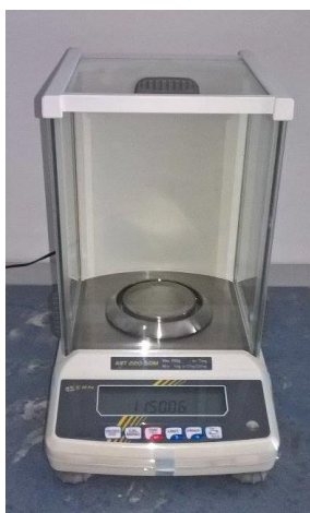
Slika 14. Analitička vaga Kern, ABT 120 4M.
