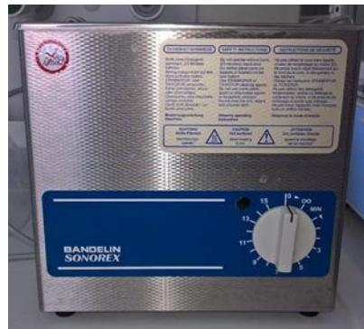
**Slika 13.** Korištena ultrazvučna kupelj.
