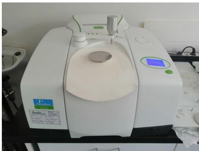
Slika 3.2: Uređaj za IR spektroskopiju PerkinElmer Frontier.
