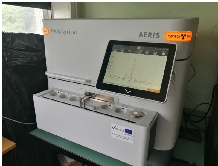
Slika 3.3: Uređaj za rendgensku difrakciju na polikristalnom uzorku PANalytical Aeris.
