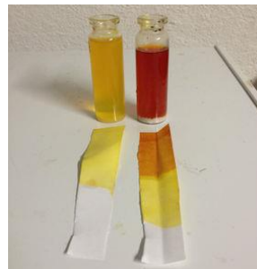
Slika 14. Kurkuma u kiseloj ili neutralnoj (lijevo) i bazičnoj sredini (desno) [39].
