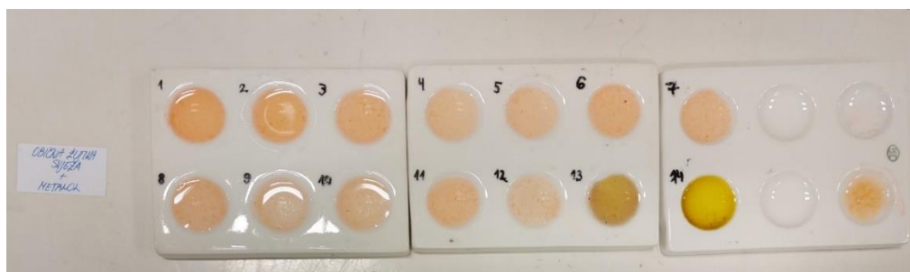
Slika 27. Indikator pripremljen od svježih bobica obične žutike i metanola.
