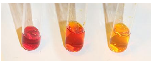
Slika 7. Metil crveno u kiselom (lijevo), neutralnom (sredina) i bazičnom (desno) mediju [19].
