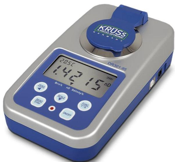
Slika 14. Refraktometar [15].
