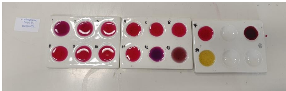
Slika 32. Indikator od svježih bobica vinobojke i metanola.
