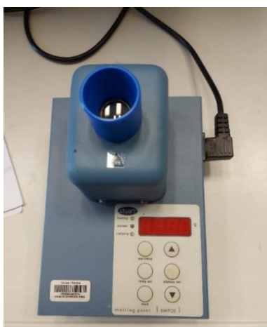
Slika 15. Stuart SMP20 digitalni uređaj za određivanje tališta.
