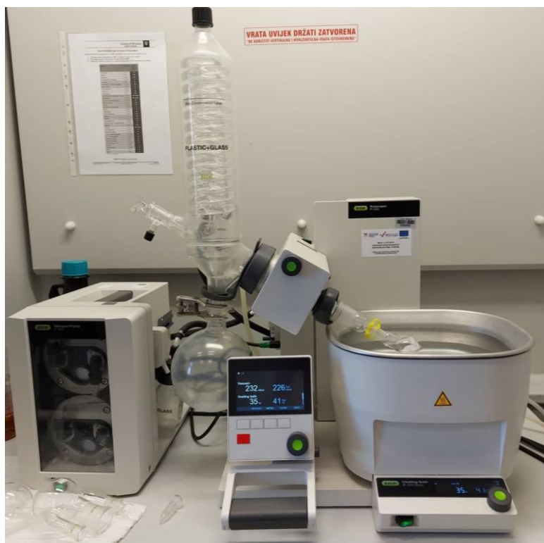
Slika 9. Rotacijski uparivač Buchi R-300 (Švicarska).
