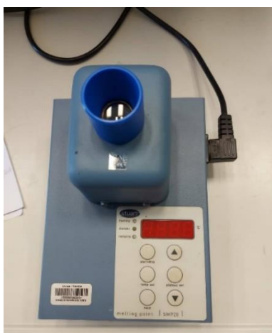
Slika 15. Stuart SMP20 digitalni uređaj za određivanje tališta.
