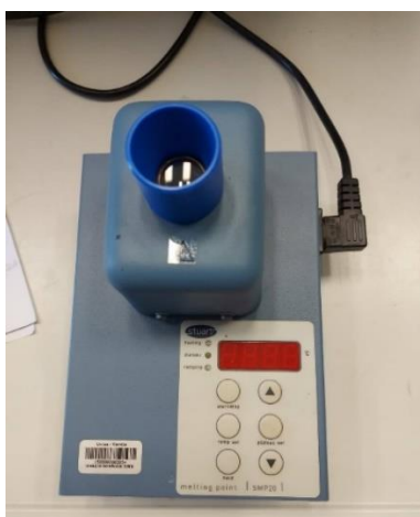
Slika 15. Stuart SMP20 digitalni uređaj za određivanje tališta.
