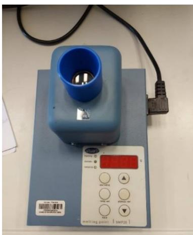
Slika 15. Stuart SMP20 digitalni uređaj za određivanje tališta.
