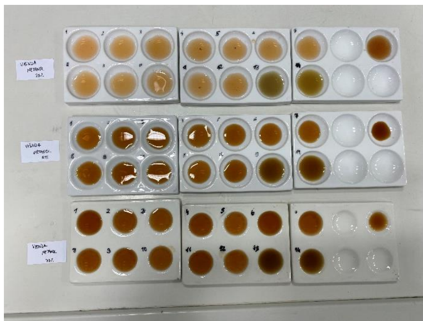
Slika 18. Indikator pripremljen od suhe višnje i metanola.
