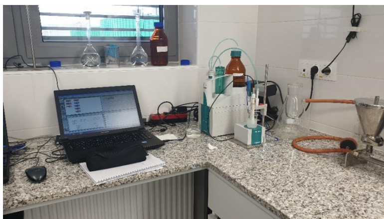
Slika 20. Sustav za potenciometrijske titracije (Titrator 808 Titrand).
