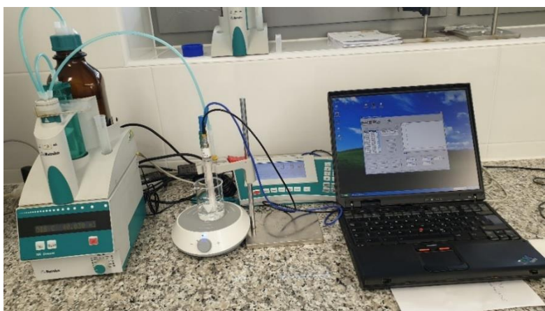
Slika 19. Sustav za potenciometrijska mjerenja odziva senzora (765 Dosimat).
