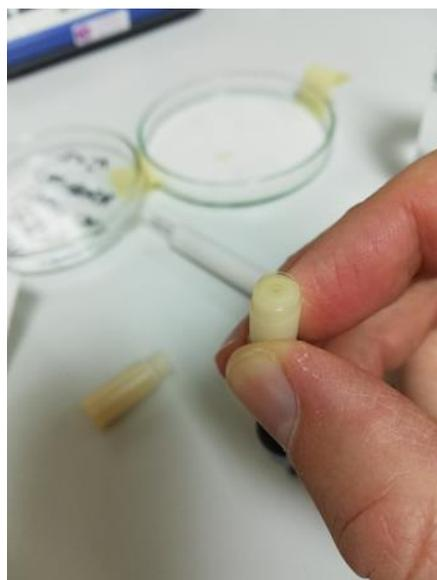
Slika 16. Priprema tijela elektrode.
