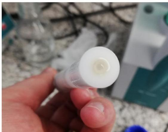
Slika 17. Membrana elektrode.
