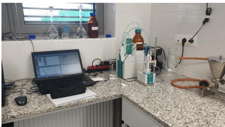
Slika 20. Sustav za potenciometrijske titracije (Titrator 808 Titrand).
