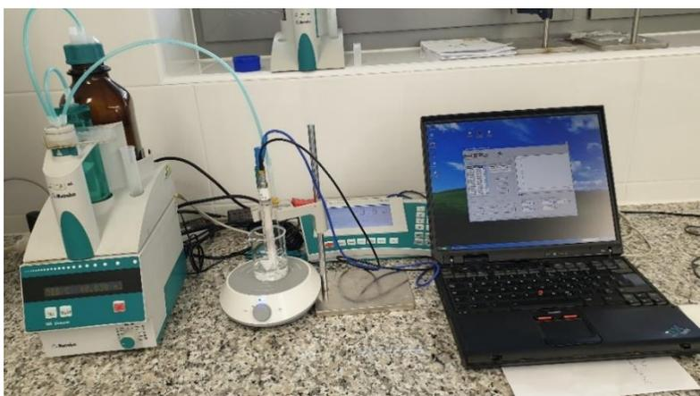
Slika 19. Sustav za potenciometrijska mjerenja odziva senzora (765 Dosimat).
