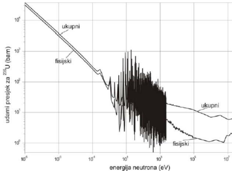
Slika 3. Udarni presjek,  $\sigma$ , za jezgru  $^{235}\text{U}$ .
