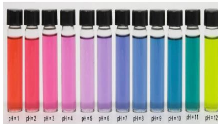
Slika 5. Promjene boje indikatora od crvenog kupusa u različitim pH [9].
