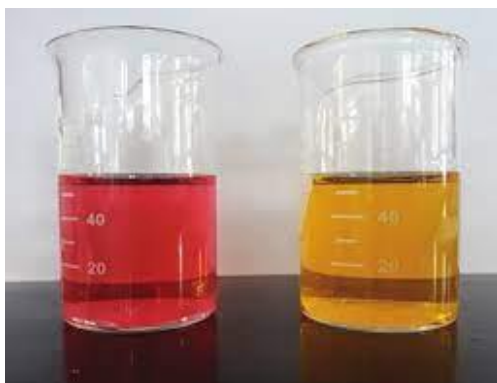
Slika 4. Promjene boje otopine metiloranža u kiseljoj (desno) i bazičnoj (lijevo) sredini [23].
