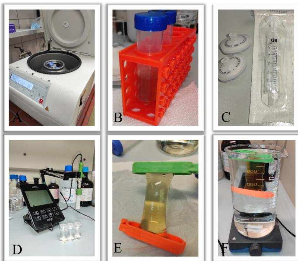
Slika 4: Prikazi: A) uređaja za centrifugu, B) Epica s uzorcima CQD, C) pribor za filtraciju uzoraka, D) pH metar i otopine za kalibraciju. Trebalo je namještati pH uzoraka na pH = 7 za dijalizu, E) uzorak u membrani za dijalizu osiguran kvačicama F) uzorak spreman za dijalizu na magnetskoj miješalici [autor].
