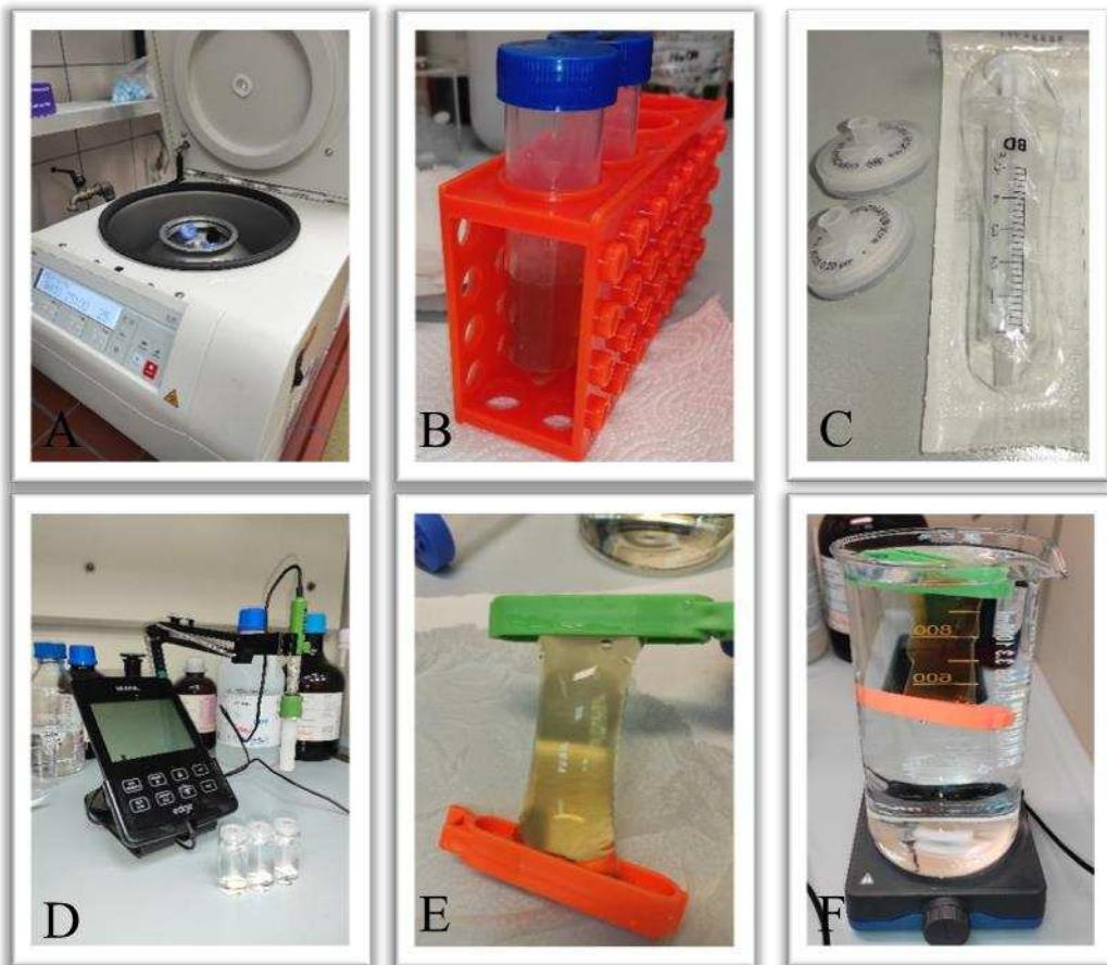
**Slika 4:** Prikazi: A) uređaja za centrifugu, B) Epica s uzorcima CQD, C) pribor za filtraciju uzorka, D) pH metar i otopine za kalibraciju. Trebalo je namještati pH uzorka na pH = 7 za dijalizu, E) uzorak u membrani za dijalizu osiguran kvačicama F) uzorak spremam za dijalizu na magnetskoj miješalici [autor].
