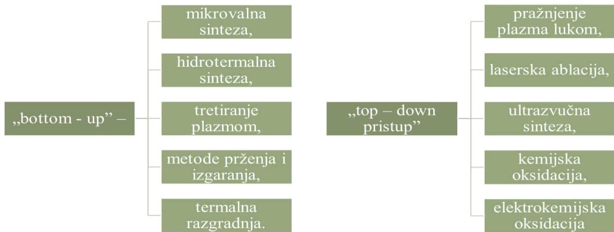
**Slika 1:** Shema prikazuje moguće postupke sinteze CQD podijeljene u dva pristupa: “*top - down*” i “*bottom - up*” koje mogu različitim kemijskim, fizikalnim ili elektrokemijskim postupcima pogodovati sintezi CQD s točno određenim svojstvima veličine i karakteristika.
