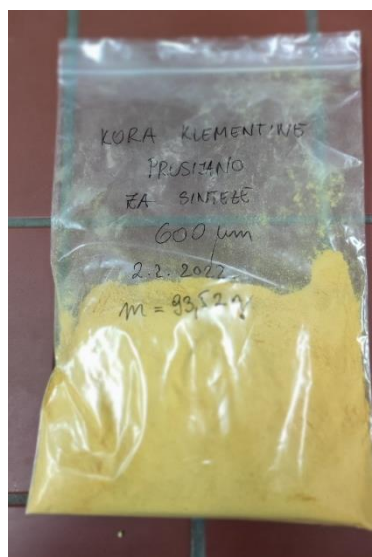
Slika 4. Prikaz liofilizirane, usitnjene i prosijane kore klementine za sinteze [autor].
