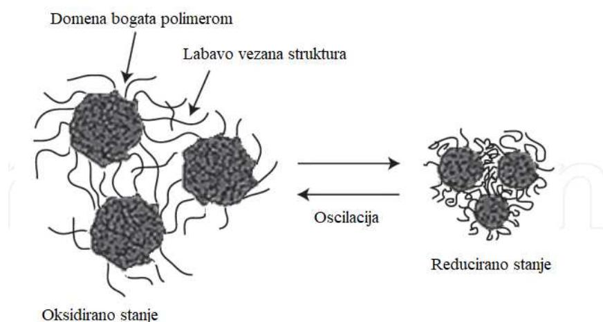
Slika 10. Prikaz tjesno i labavo vezane strukture unutar domene bogate polimerom [2].
