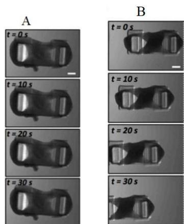
Slika 26. A-lokomocija simetričnog bio-bota, B- lokomocija asimetričnog biobota [5].
