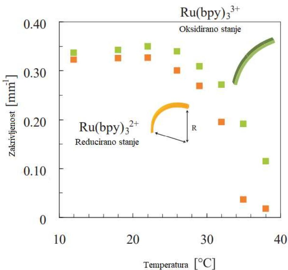
Slika 6. Ravnotežni omjer bubrenja izražen kao zakrivljenost poli(NIPAAm-co-Ru(bpy)<sub>3</sub>-co-AMPS gel trake u otopinama cerijevog sulfata kao funkcija temperature [2].
