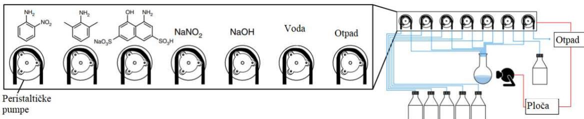
Slika 19. Shematski prikaz zadatka svake peristaltičke pumpe [4].
