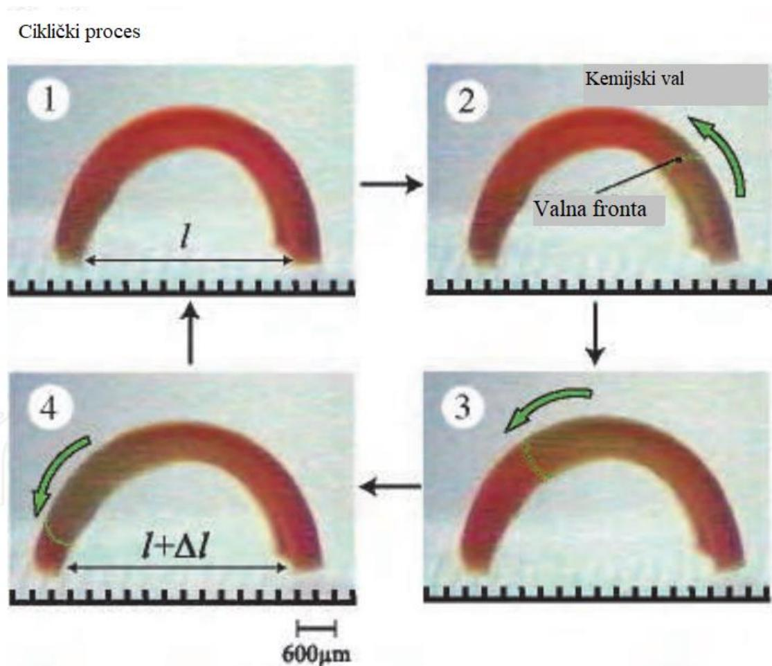
Slika 7. Prikaz pokreta putem savijanja i izvijanja gela.  $l$  je udaljenost između dva ruba zakriviljene gel trake u reduciranoj stanju.  $\Delta l$  je promjena položaja udaljenosti nakon propagacije kemijskog vala [2].
