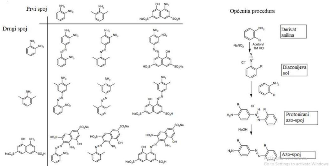
Slika 20. Prikaz derivata anilina i 9 mogućih spojeva [4].
