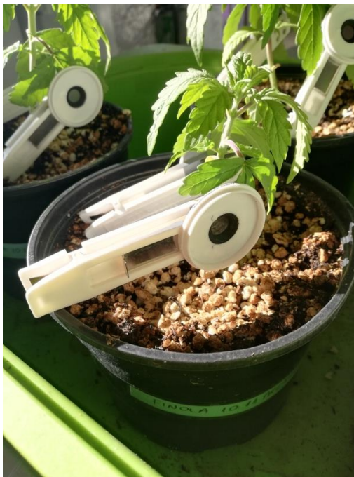
Slika 13. Postavljanje kvačica sa zatvorenim poklopcima kako bi se listovi prilagodili uvjetima tame za mjerenje fluorescencije klorofila a .
