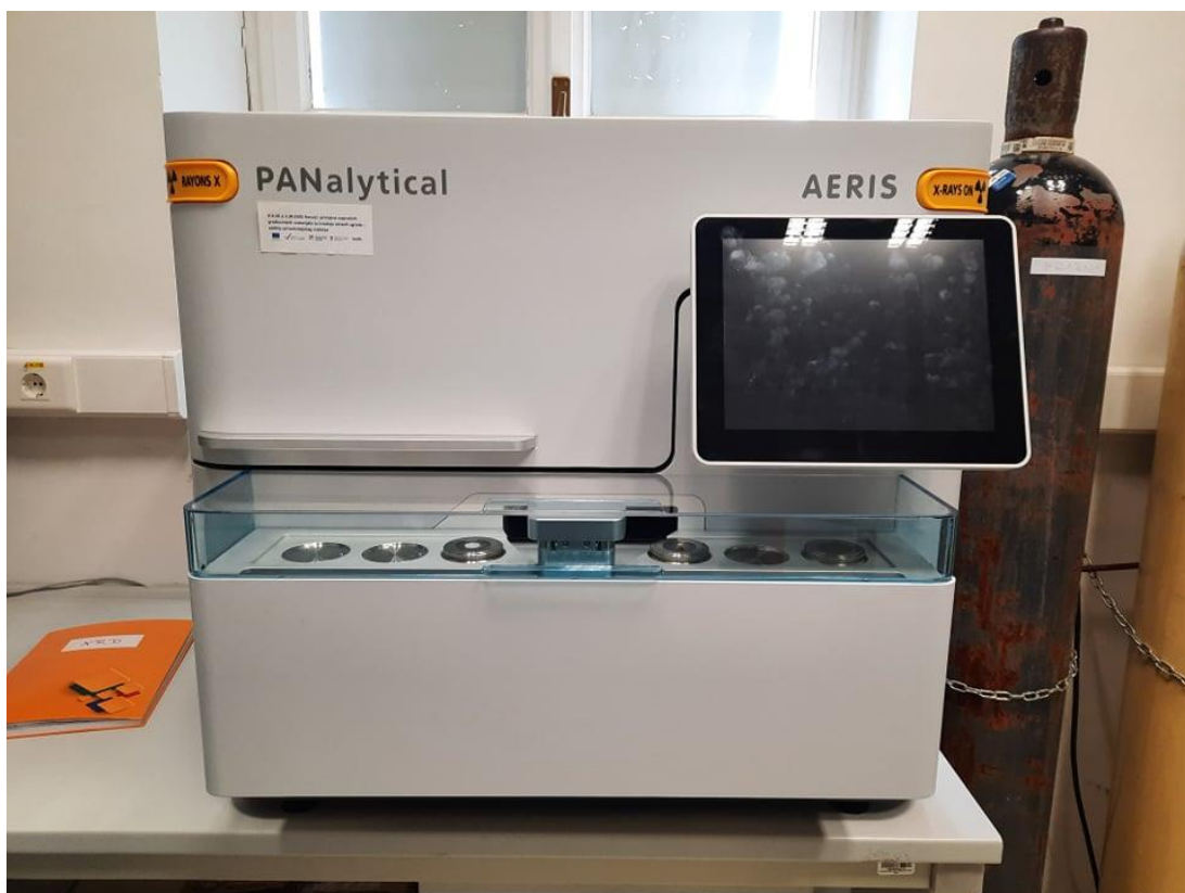
Slika 15. Slika aparature za rendgensku difrakciju na prahu.
