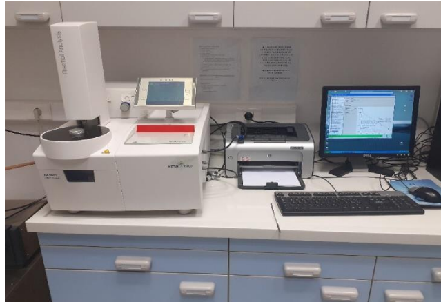
Slika 14. Prikaz uređaja za TG analizu.
