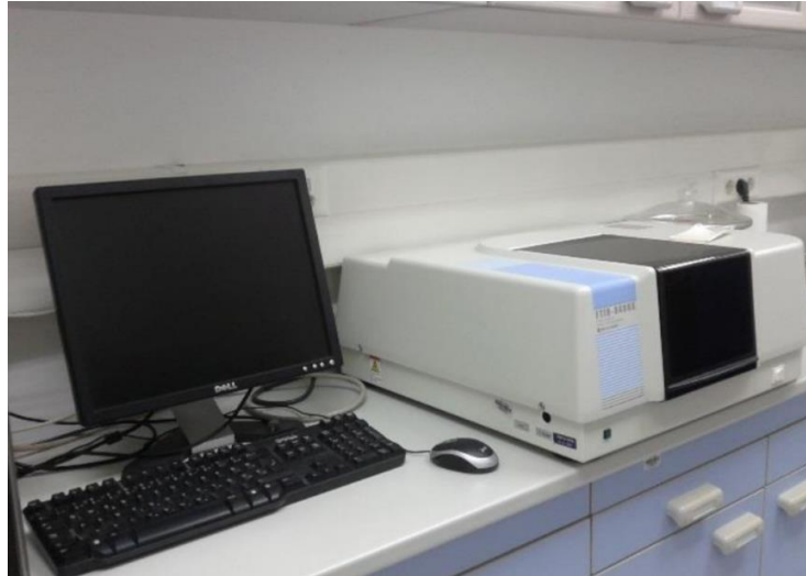
Slika 13. Aparatura za FT-IR.
