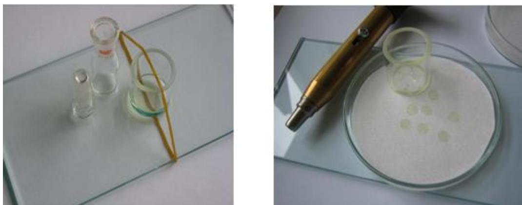
**Slika 8: Izrada senzorske PVC membrane za tenzidnu elektrodu**
