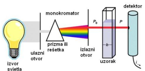
Slika 5. Shematski prikaz UV/VIS spektrofotometra [18].
