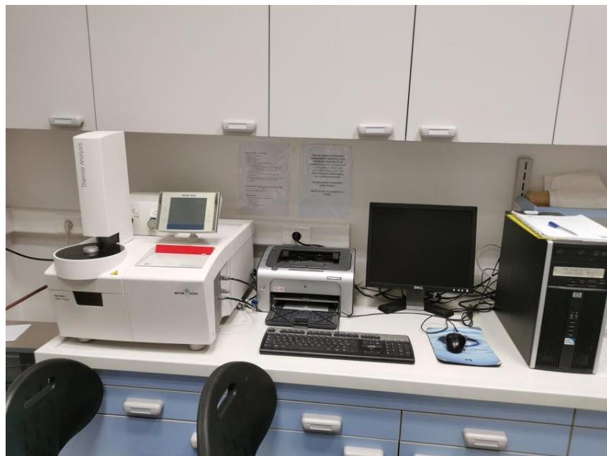
**Slika 8.** Uređaj za termogravimetrijsku analizu.
