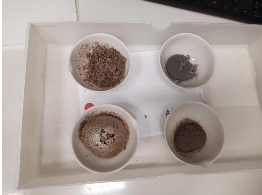
Slika 15. Nastali fini prah nakon kalcinacije pri 600°C.
