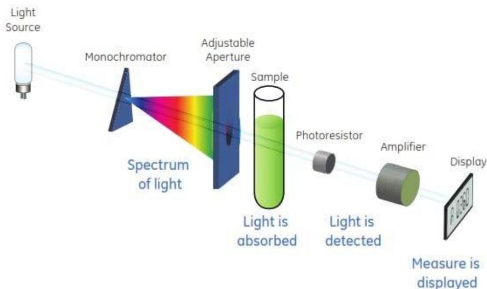
**Slika 10.** Shematski prikaz konfiguracije UV/Vis spektrofotometra [44].
