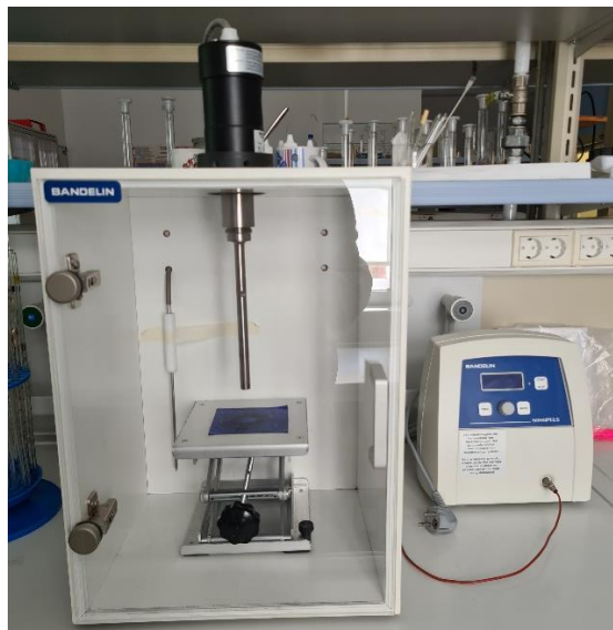
Slika 12. Uređaj za sonokemijsku sintezu sa sondom Sonoplus 3100, Bandelin.
