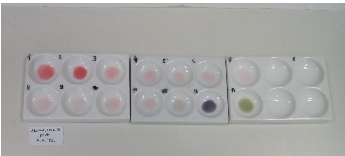
Slika 193. Reciklirani indikator pripremljen od svježe aronije u etanolu, 4. 6. 2022.
