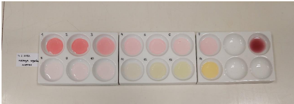
Slika 79. Indikator pripremljen od svježe aronije u acetonu, 4. 2. 2022.
