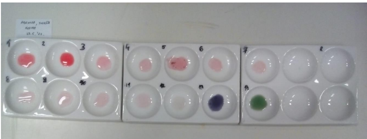
Slika 150. Indikator pripremljen od svježe aronije u metanolu, 27. 5. 2022.
