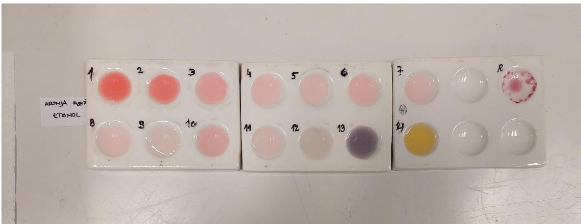
Slika 184. Indikator pripremljen od svježe aronije u etanolu, 6. 5. 2022.
