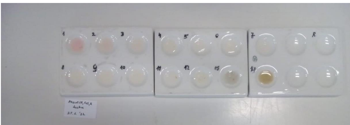
Slika 116. Reciklirani indikator pripremljen od svježe aronije u acetonu, 25. 6. 2022.
