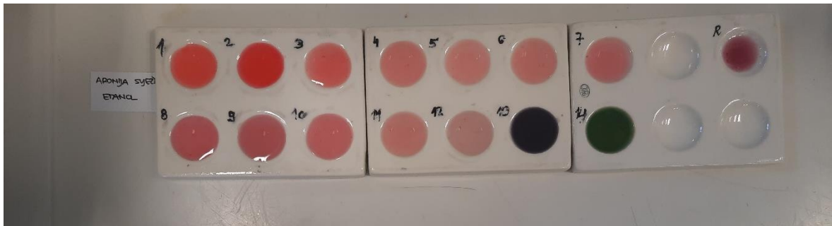
Slika 186. Indikator pripremljen od svježe aronije u etanolu, 13. 5. 2022.
