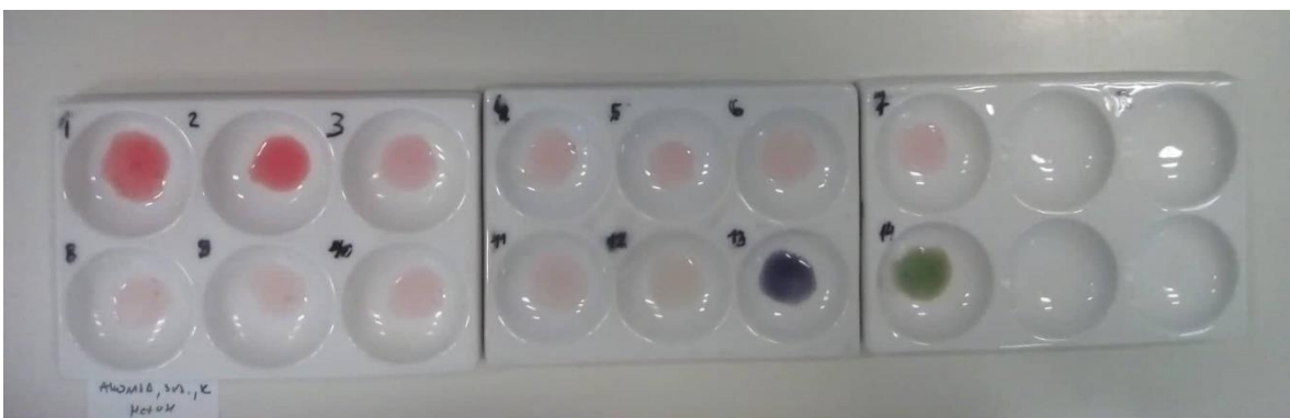
Slika 156. Reciklirani indikator pripremljen od svježe aronije u metanolu, 25. 6. 2022.
