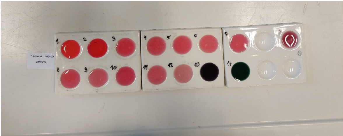
Slika 182. Indikator pripremljen od svježe aronije u etanolu, 29. 4. 2022.
