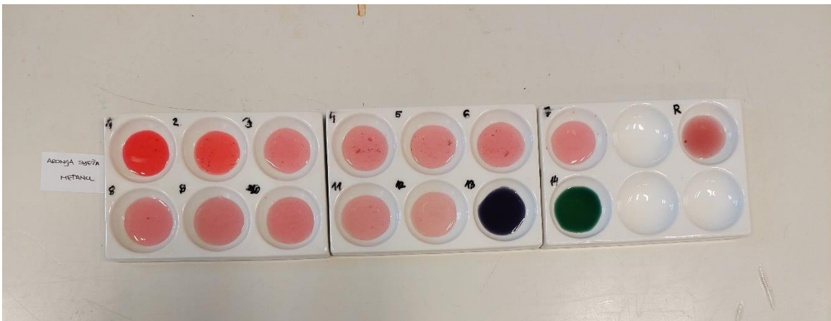
Slika 142. Indikator pripremljen od svježe aronije u metanolu, 29. 4. 2022.
