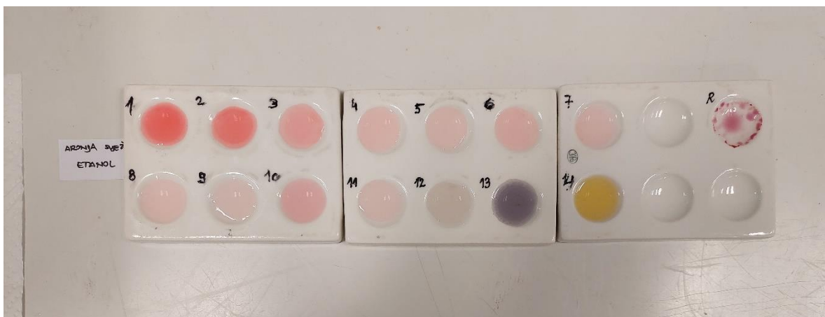
Slika 184. Indikator pripremljen od svježe aronije u etanolu, 6. 5. 2022.
