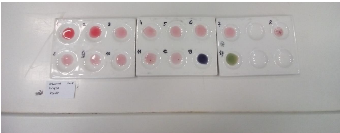
Slika 148. Indikator pripremljen od svježe aronije u metanolu, 20. 5. 2022.
