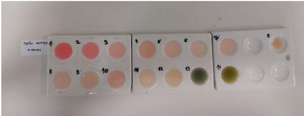
Slika 88. Indikator pripremljen od svježe aronije u acetonu, 8. 3. 2022.
