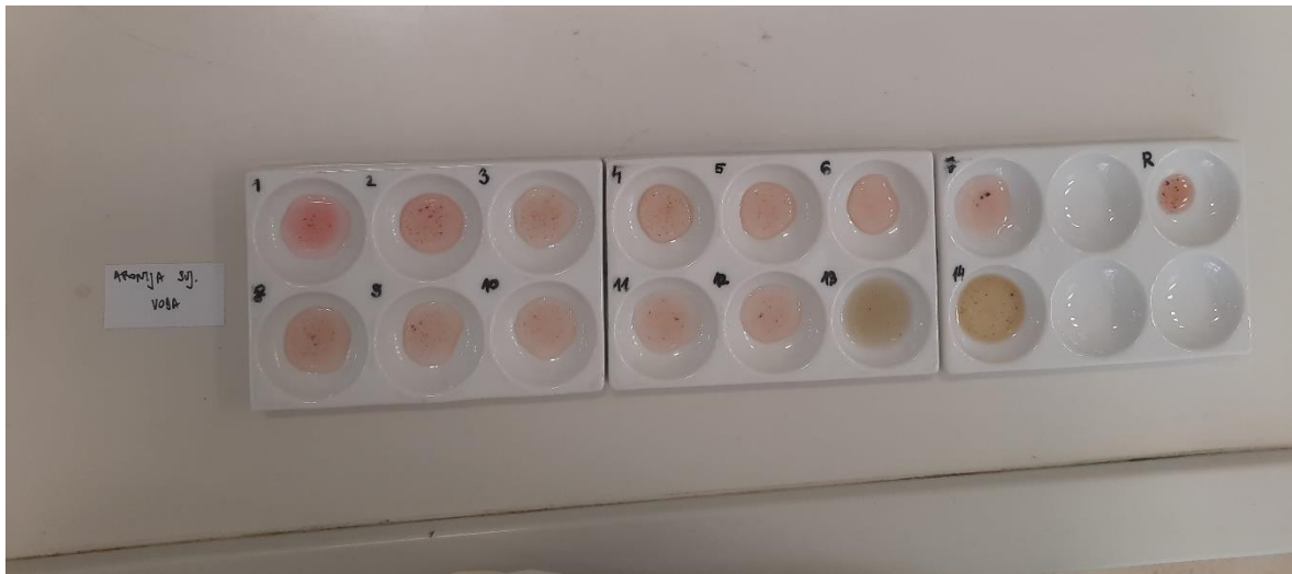
Slika 32. Indikator pripremljen od svježe aronije u hladnoj vodi, 26. 4. 2022.
