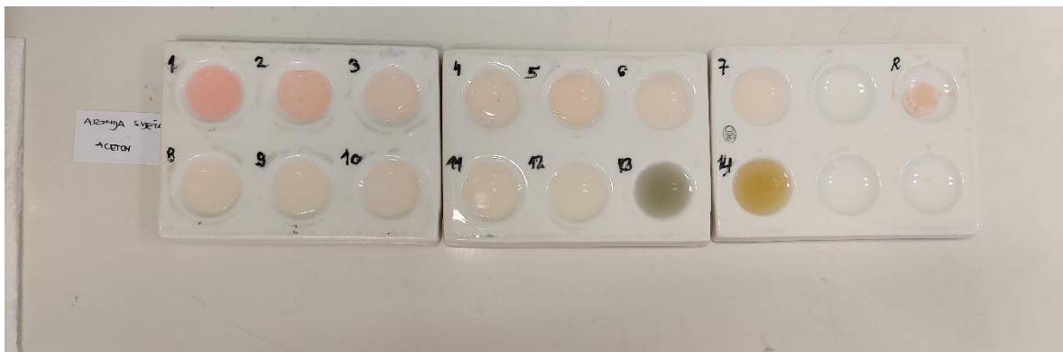
Slika 98. Indikator pripremljen od svježe aronije u acetonu, 12. 4. 2022.
