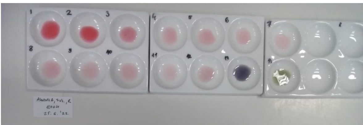
Slika 196. Reciklirani indikator pripremljen od svježe aronije u etanolu 25. 6. 2022.
