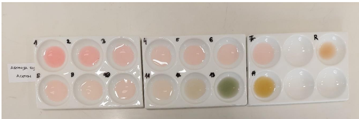
Slika 84. Indikator pripremljen od svježe aronije u acetonu, 22. 2. 2022.
