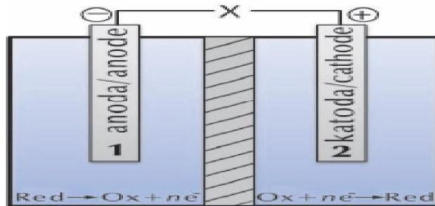
Slika 18. Shematski prikaz jediničnog članka za galvanski članak.
