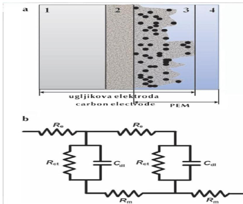
Slika 22. a) Tipična konfiguracija kontaktnog područja između ugljikove elektrode i PEM-a u PEMFC-u: 1 – elektrodna podloga, 2 – čestice ugljikova praha, 3 – smjesa čestica ugljikovog praha, katalizatora i PEM-a, 4 – PEM, b) EEC za aproksimaciju elektrodne impedancije
