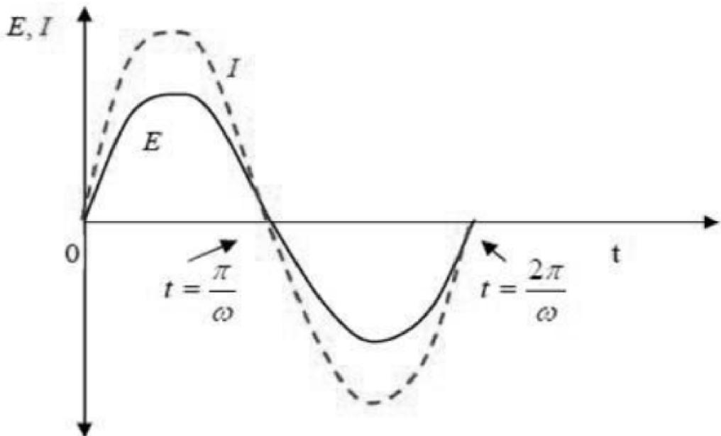
Slika 6 .Rezultirajuća struja kod kruga s otpornikom
