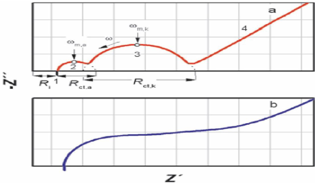
Slika 20. Tipični IS-i galvanskog čanka (baterije) prikazani u kompleksnoj ravnini impedancije za sljedeće slučajeve: a)  $\omega_{m,a}(\tau_a) \neq \omega_{m,k}(\tau_k)$  i b)  $\omega_{m,a}(\tau_a) \approx (\tau_k)$
