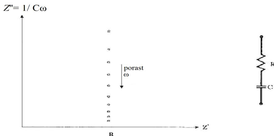
Slika 2. Nyquistov dijagram za jednostavni serijski spoj otporne i kapacitivne komponente.
