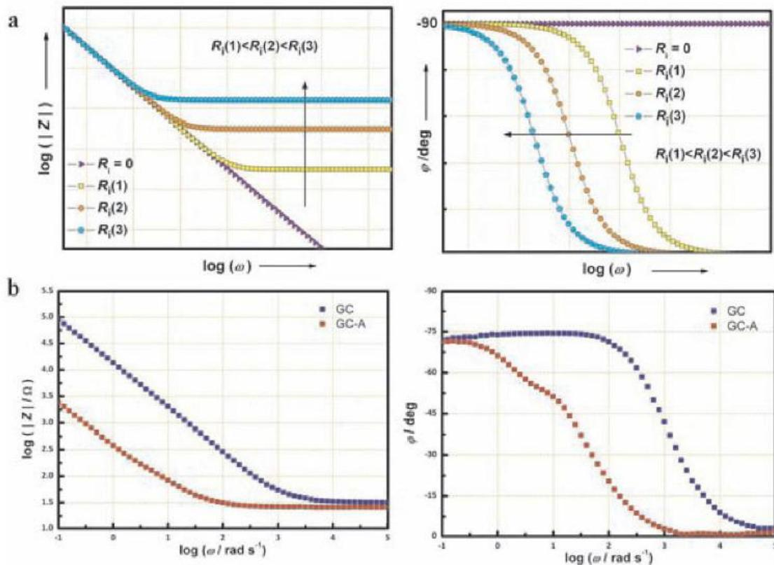
Slika 17. (a) Utjecaj povećanja  $R_i$  na simulirane IS-e (Bodeov prikaz) idealnog kondenzatora, (b) eksperimentalni IS-i (Bodeov prikaz) neaktivirane, GC, i aktivirane GC-A, staklaste ugljikove elektrode u  $0,5 \text{ mol dm}^{-3} \text{ H}_2\text{SO}_4$ .
