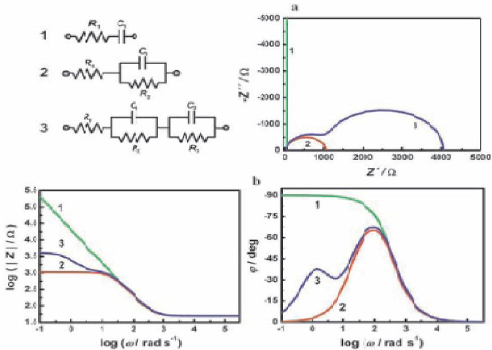
Slika 5. Grafički prikaz simuliranih IS-a za dane EEC-e u: a) kompleksnoj ravnini impedancije i b) Bodeovu prikazu. Vrijednosti parametara su:  $R_1 = 50 \Omega$ ,  $C_1 = 5 * 10^{-5} F$ ,  $R_2 = 1000 \Omega$ ,  $C_2 = 5 * 10^{-4} F$ ,  $R_3 = 3000 \Omega$
