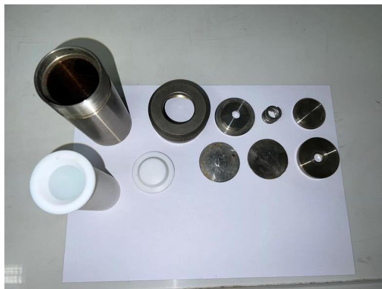
**Slika 6.** Prikaz dijelova autoklava i teflonskog uloška (bijelo) koji čine zatvoreni sustav za solvotermalne reakcije.
