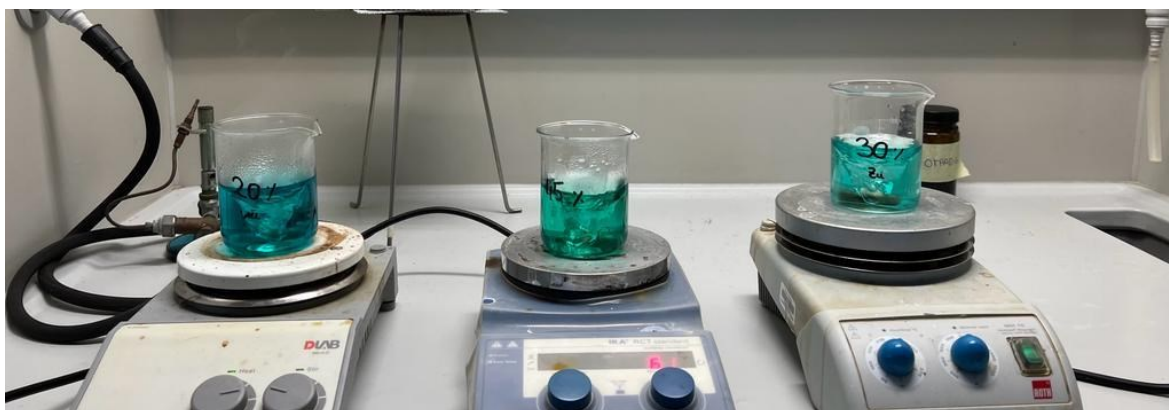
Slika 14. Sinteza litij-niklovih oksida na magnetskim mješalicama s grijanjem.
