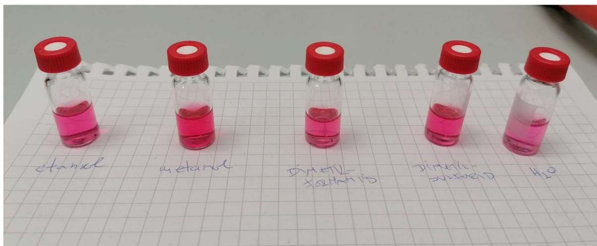
Slika 15. Ispitivanje topljivosti vitamina B12 u različitim otapalima.
