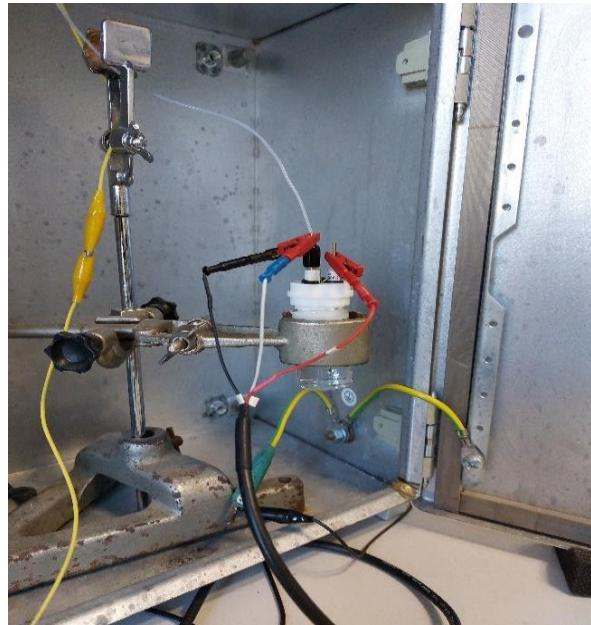
**Slika 9.** Prikaz troelektrodnog sustava u elektrokemijskoj ćeliji.
