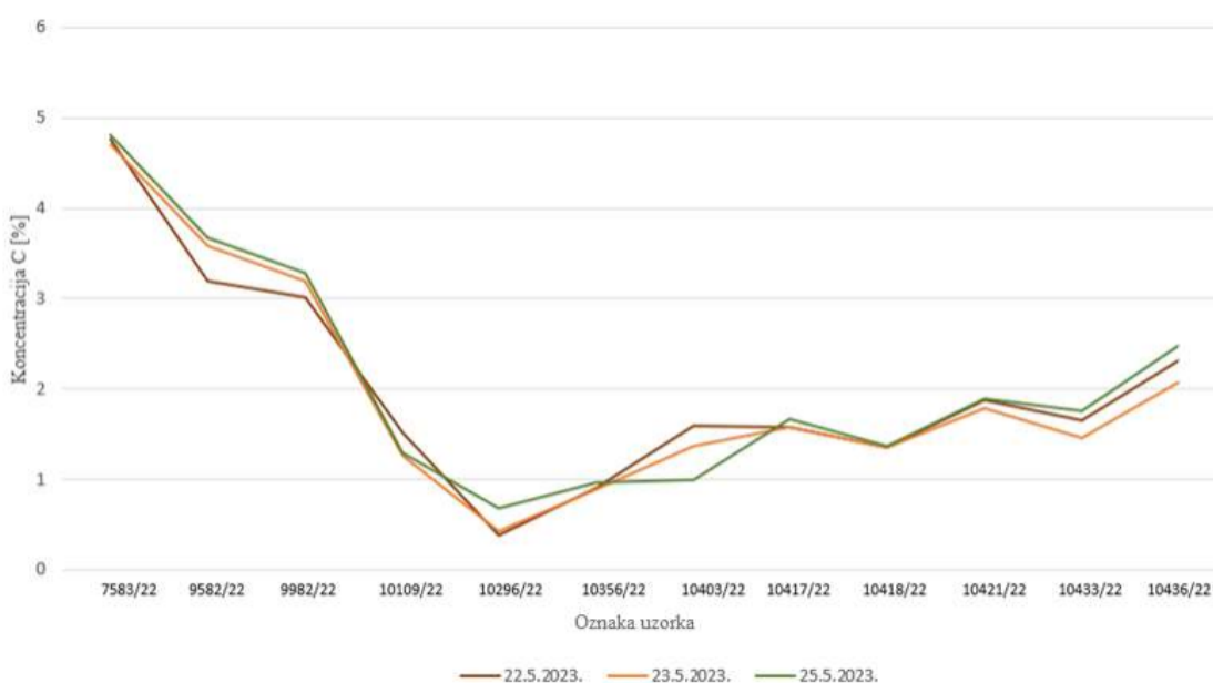
Slika 17. Grafički prikaz srednje vrijednosti dobivenih rezultata koncentracije organskog ugljika uporabom metode mokrog spaljivanja.
