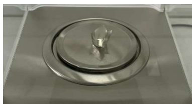
Slika 12. Kositrena lađica za vaganje uzoraka.
