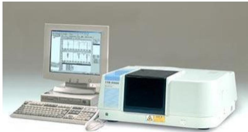
Slika 20. Spektrometar SHIMADZU FTIR-8400S. (izvor:
