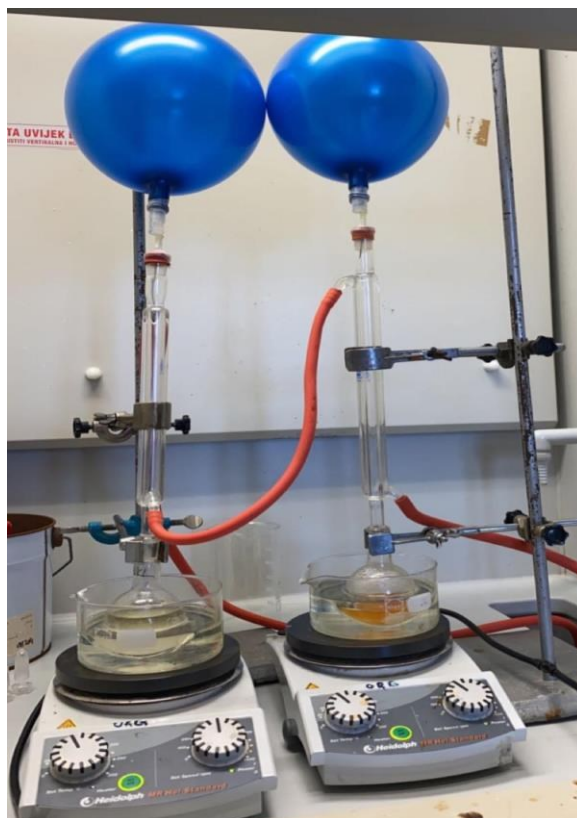
Slika 17. Aparatura za sintezu 2-fenil-1,4-dioktadecil-1 H -imidazol-3-ijeva bromida (1) i 4-metil-1,3-dioktadecil-1 H -imidazol-3-ijeva bromida (2)
