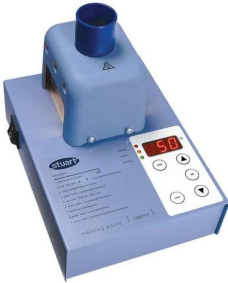
Slika 19. Digitalni uređaj za određivanje tališta Stuart SMP20 (izvor:
