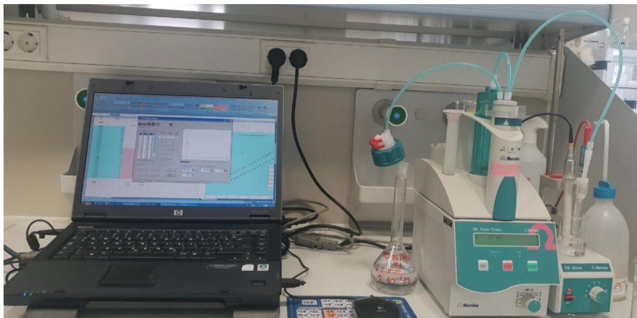
SLIKA 5. Aparatura za direktnu potenciometriju.
