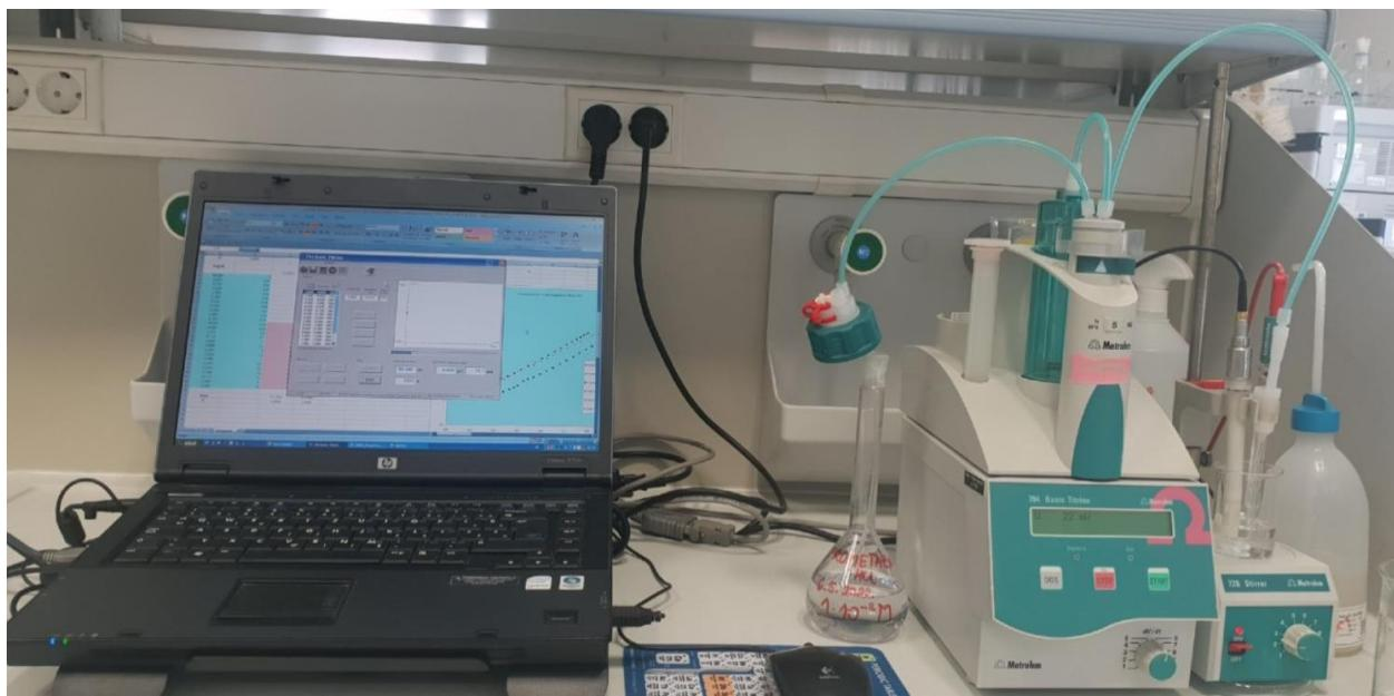
SLIKA 5. Aparatura za direktnu potenciometriju.
