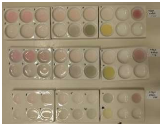
Slika 14. Indikator pripremljen od svježe višnje i etanola. Gore – 1 : 10, sredina – 1 : 15 i dolje – 1 : 20.
