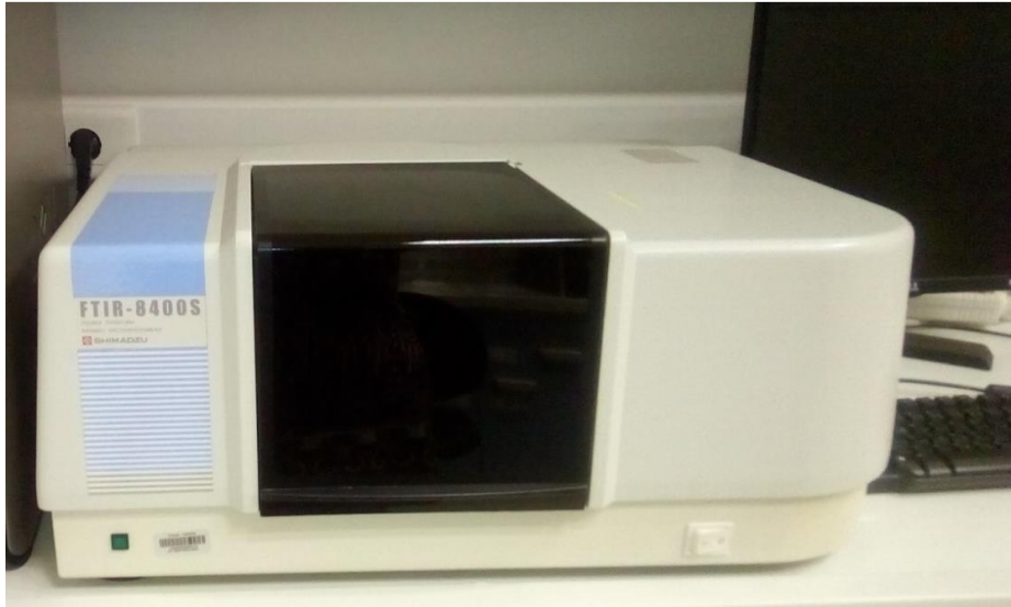
Slika 3. FTIR-8400S SHIMADZU spektrofotometar
