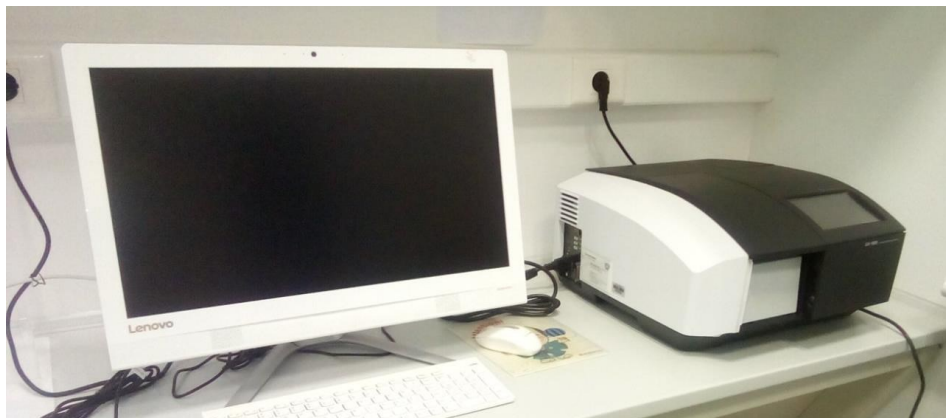
Slika 4. SHIMADZU UV-1900 UV-VIS spektrofotometar
