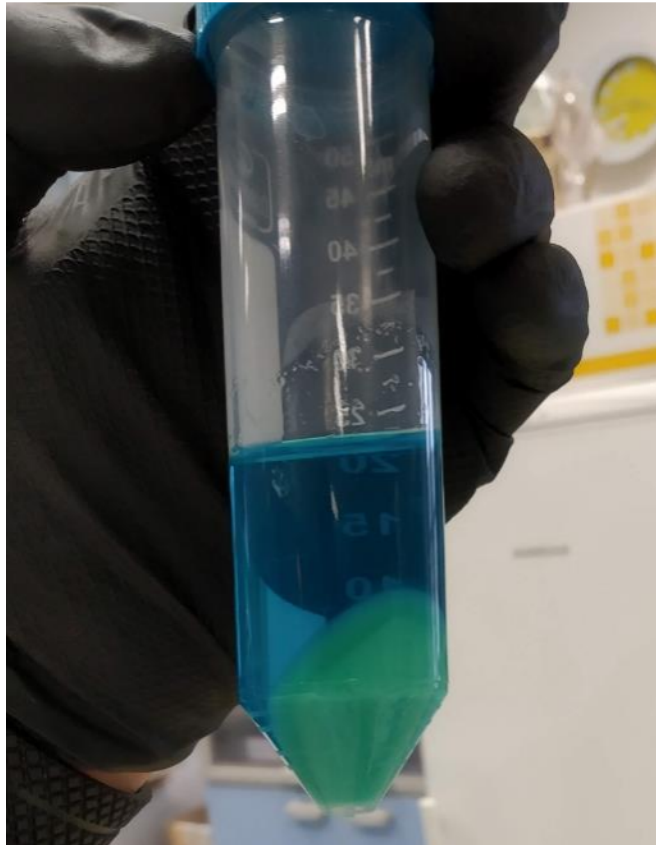
Slika 18. Odvojeni zeleni talog i plavi supernatant nakon centrifuge.
