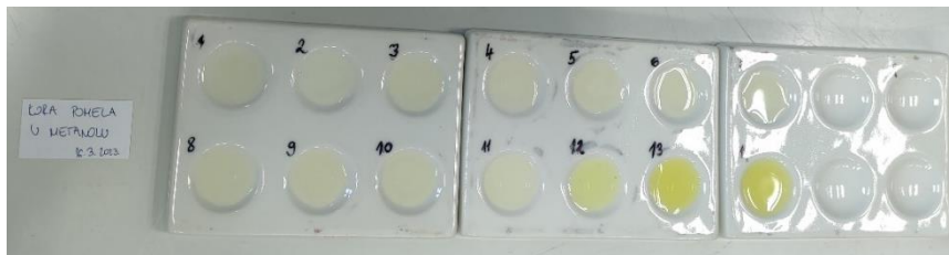
Slika 39. Indikator pripremljen od kore pomela i metanola.
