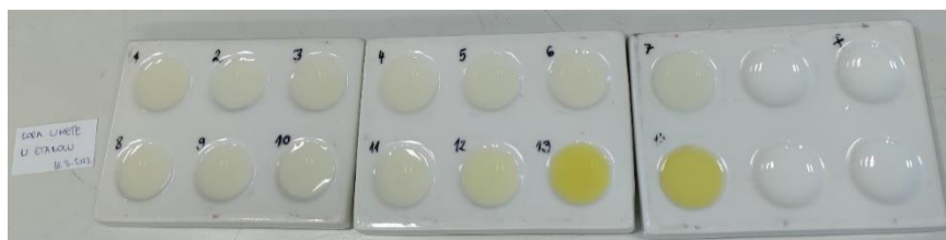
Slika 49. Indikator pripremljen od kore limete i etanola.
