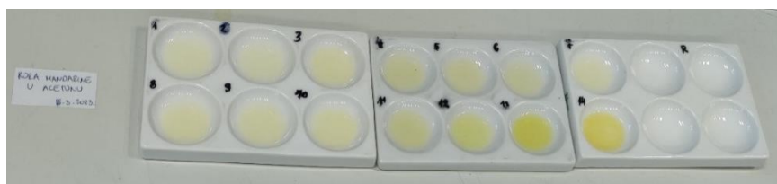
Slika 54. Indikator pripremljen od kore mandarine i acetona.
